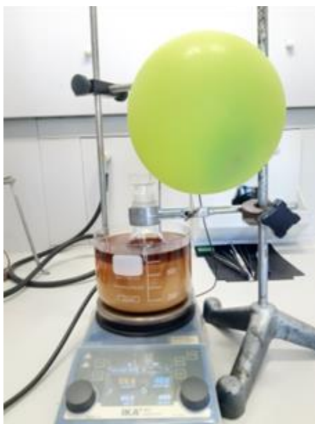
Slika 17. Reakcija dobivanja PEDOT-g-PAU:S-SEBS kompozita
