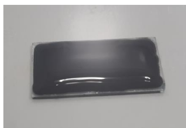
Slika 19. Disperzija nanosena na staklenu pločicu
