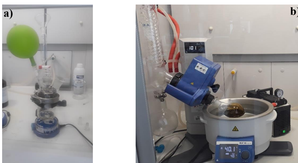
Slika 3.4. a) Sinteza PEDOT-Br makroinicijatora; b) rotacijski uparivač
