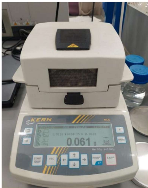
Slika 18. Analizator vlage (MLS-50-3C, Kern & Sohn).
