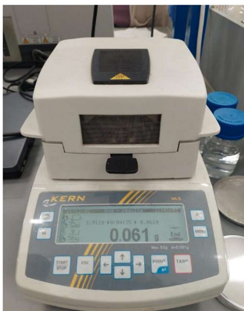
Slika 18. Analizator vlage (MLS-50-3C, Kern & Sohn).
