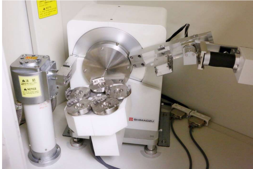
Slika 25. Difraktometar za karakterizaciju kristala, Shimadzu XRD 6000 .
