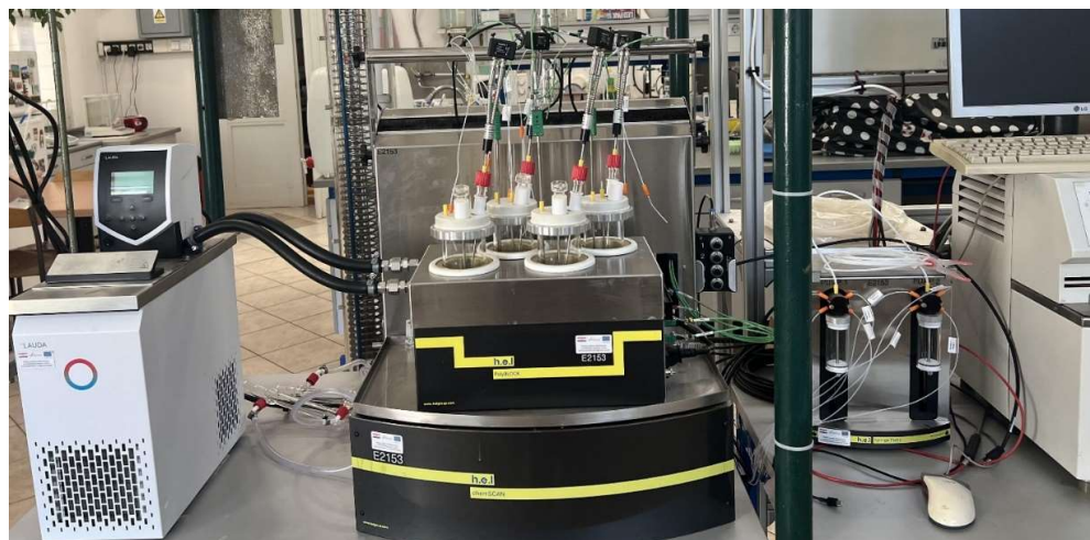
Slika 16. Uređaj CrystalSCAN korišten za provedbu procesa kristalizacije.
