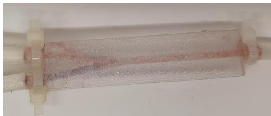
Slika 71. Mikroreaktor 50 s nakon početka protjecanja otopina (protok kiseline: 50 \mu\text{L}/\text{min} ; protok baze: 500 \mu\text{L}/\text{min} ).
