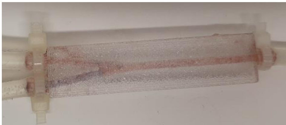
Slika 70. Mikroreaktor 40 s nakon početka protjecanja otopina (protok kiseline: 50 \mu\text{L}/\text{min} ; protok baze: 500 \mu\text{L}/\text{min} ).
