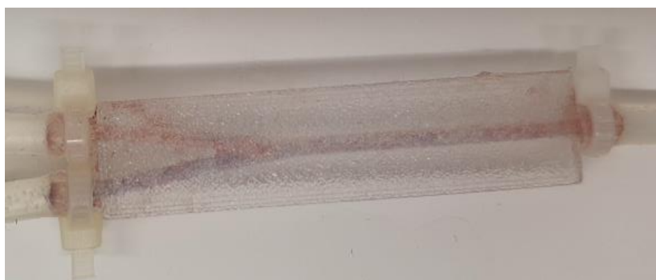
Slika 73. Mikroreaktor 70 s nakon početka protjecanja otopina (protok kiseline: 50 \mu\text{L}/\text{min} ; protok baze: 500 \mu\text{L}/\text{min} ).
