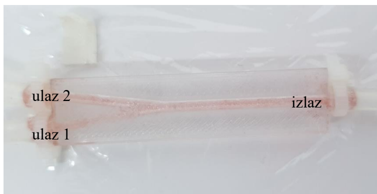
Slika 49. Mikroreaktor prije protjecanja pH otopina.
