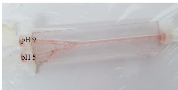
Slika 61. Mikroreaktor nakon 5 s od zamjene cjevčica i protjecanja otopina (pH 9 i pH 5).
