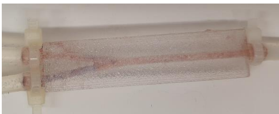
Slika 68. Mikoreaktor 20 s nakon početka protjecanja otopina (protok kiseline: 500 \mu\text{L}/\text{min} ; protok baze: 50 \mu\text{L}/\text{min} ).
