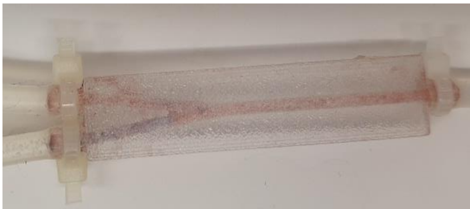
Slika 69. Mikroreaktor 30 s nakon početka protjecanja otopina (protok kiseline: 500 \mu\text{L}/\text{min} ; protok baze: 50 \mu\text{L}/\text{min} ).
