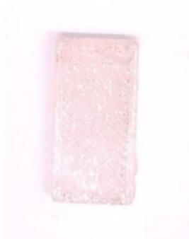
Slika 21. Pločica nakon 10 minuta u otopini: pH 4,0.
