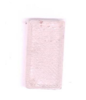
Slika 25. Pločica nakon 10 minuta u otopini: pH 8,1.
