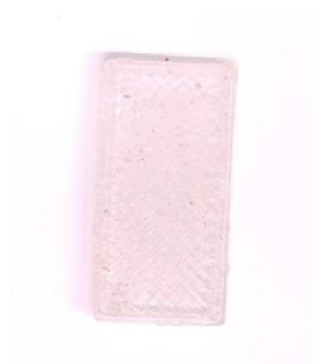
Slika 23. Pločica nakon 10 minuta u otopini: pH 6,1.
