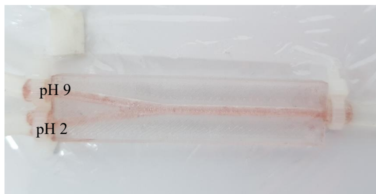
Slika 54. Mikroreaktor nakon 5 min od zamjene cjevčica i protjecanja otopina (pH 9 i pH 2).
