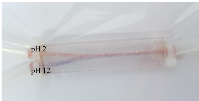
Slika 32. Mikroreaktor nakon 1 min protjecanja otopina (pH 2 i pH 12).
