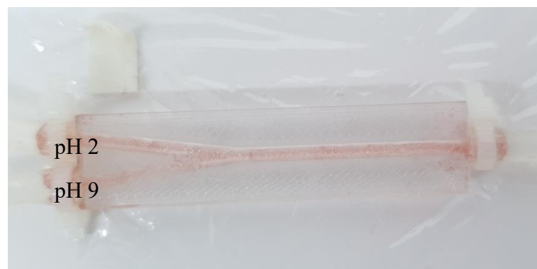
Slika 51. Mikroreaktor nakon 5 min protjecanja otopina (pH 2 i pH 9).
