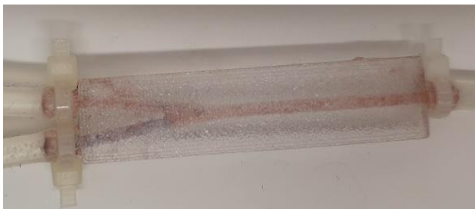
Slika 70. Mikroreaktor 40 s nakon početka protjecanja otopina (protok kiseline: 50 \mu\text{L}/\text{min} ; protok baze: 500 \mu\text{L}/\text{min} ).
