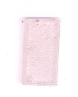
Slika 25. Pločica nakon 10 minuta u otopini: pH 8,1.
