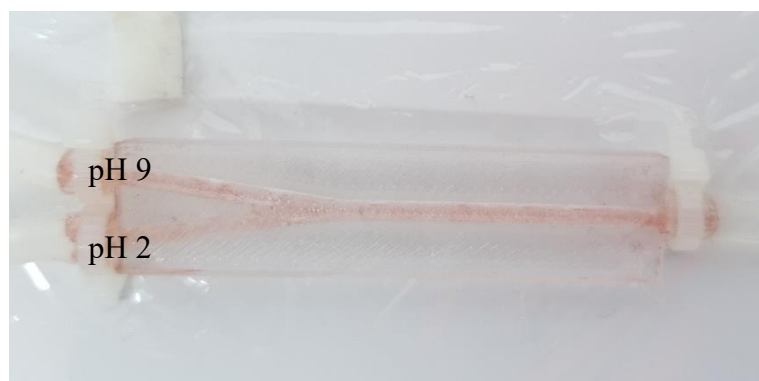
Slika 53. Mikroreaktor nakon 1 min od zamjene cjevčica i protjecanja otopina (pH 9 i pH 2).
