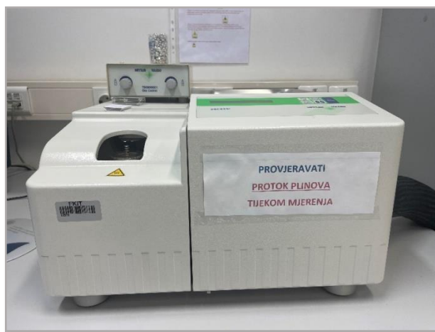
Slika 23. DSC uređaj Mettler Toledo DSC 823e
