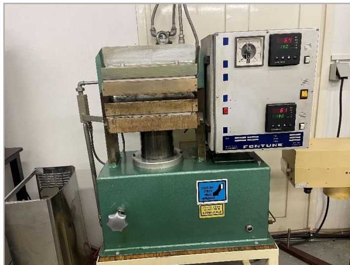
Slika 20. Hidraulička preša Fontune
