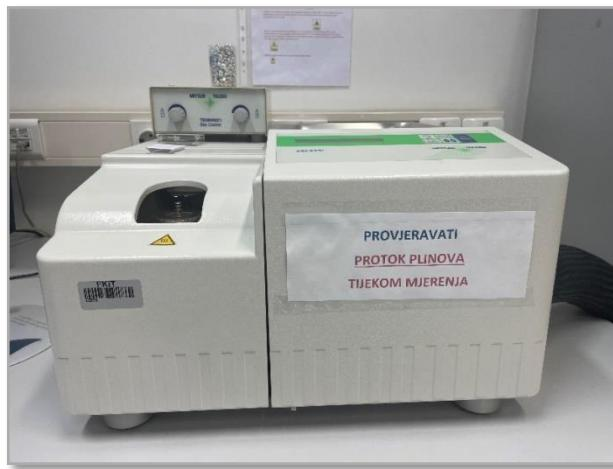
Slika 23. DSC uređaj Mettler Toledo DSC 823e
