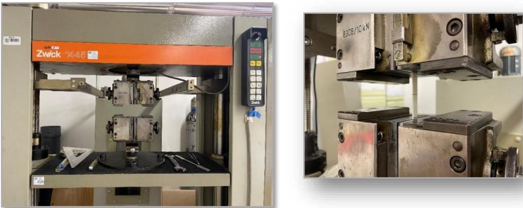
Slika 25. Mehanička kidalica Zwick 1445 (lijevo), uzorak u mehaničkoj kidalici (desno)
