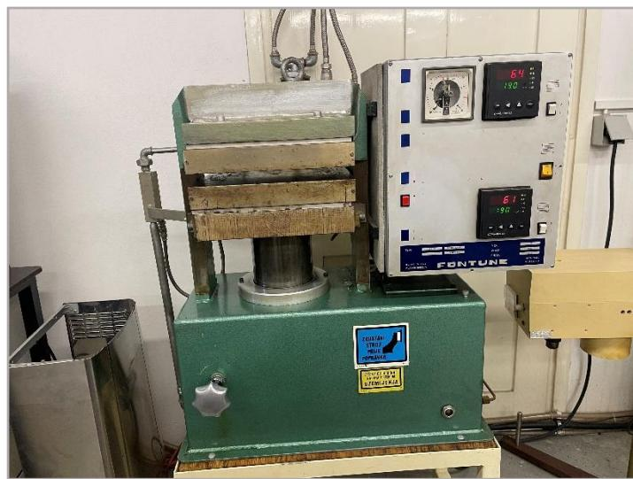
Slika 20. Hidraulička preša *Fontune*
