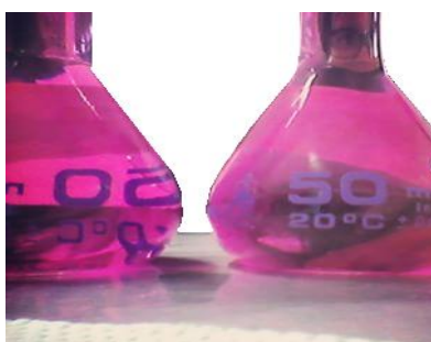
Slika 16. Prikaz obojenih otopina za određivanje nitrita
