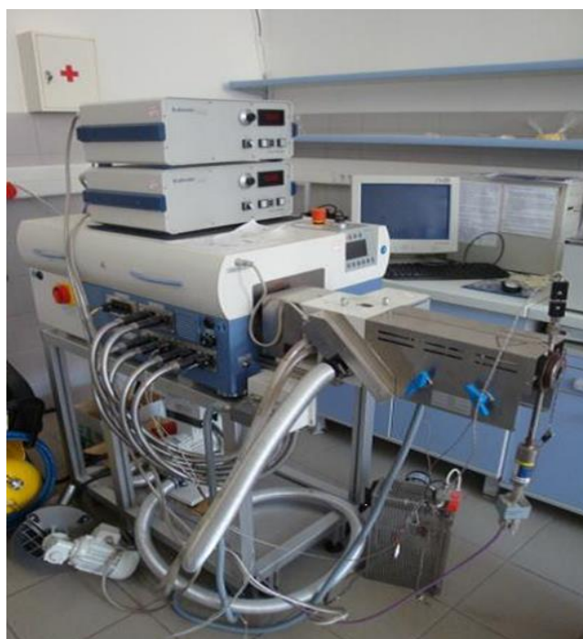
Slika 28. Laboratorijski jednopužni ekstruder Brabender 19/20 DN
