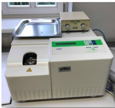
Slika 31. DSC uređaj Mettler Toledo DSC 822e
