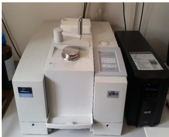
Slika 32. FTIR-ATR spektrofotometar Spectrum One, Perkin Elmer
