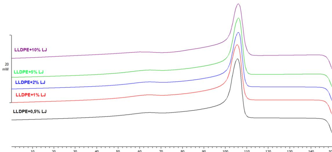
Slika 34. DSC krivulje hlađenja čistog LLDPE i LLDPE/LJJ biokompozita
