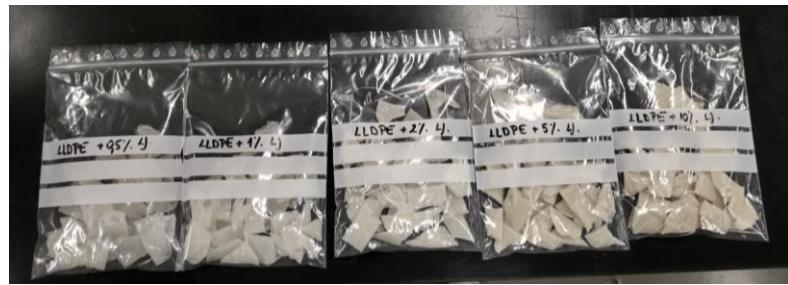
Slika 29. Uzorci LLDPE/LJJ biokompozita nakon umješavanja na Brandeder gnjetilici
