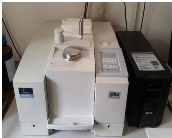
Slika 32. FTIR-ATR spektrofotometar Spectrum One, Perkin Elmer
