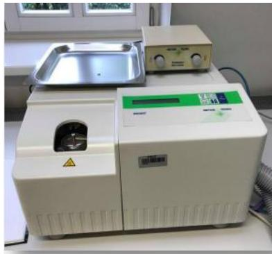
Slika 31. DSC uređaj Mettler Toledo DSC 822e
