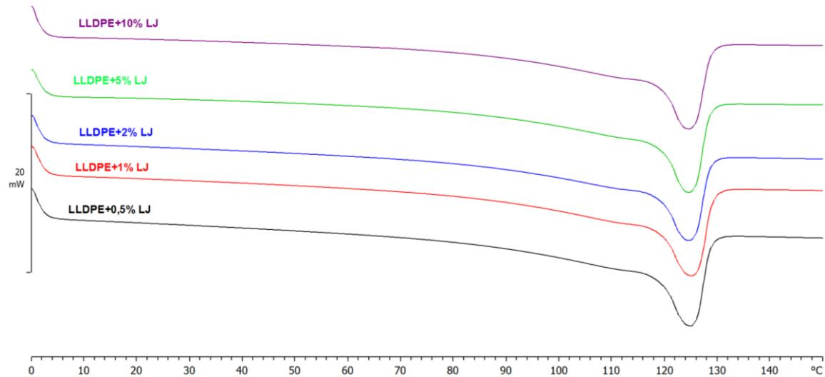
Slika 33. DSC krivulje zagrijavanja čistog LLDPE i LLDPE/LJJ biokompozita
