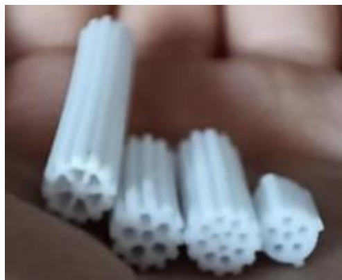
Slika 6. Uzorci monolita različite geometrije i veličine
