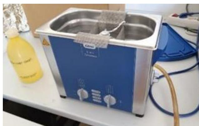
Slika 10. Ultrazvučna kupelj
