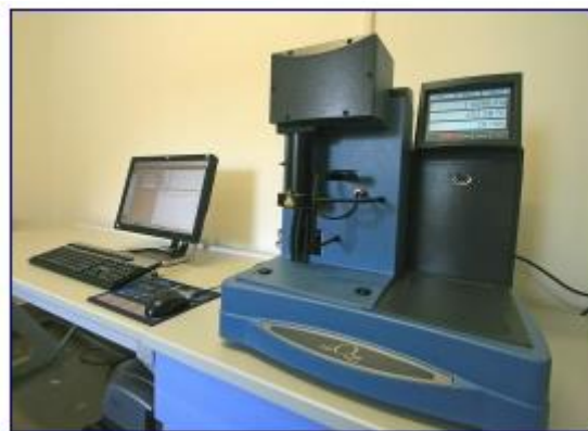
Slika 3.3 Termogravimetar TA Instruments Q500
