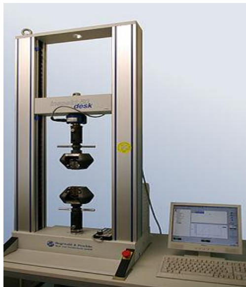
Slika 3.1 Univerzalna kidalica, metoda naprezanje-istezanje
