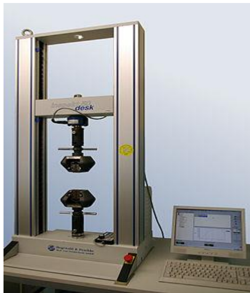
Slika 3.1 Univerzalna kidalica, metoda naprezanje-istezanje
