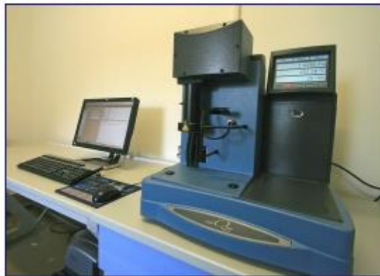
Slika 3.3 Termogravimetar TA Instruments Q500
