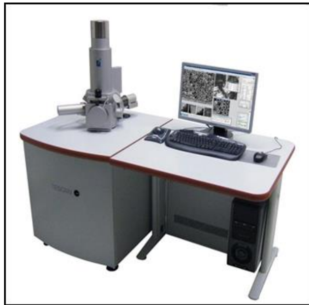
Slika 3.4 Pretražni elektronski mikroskop
