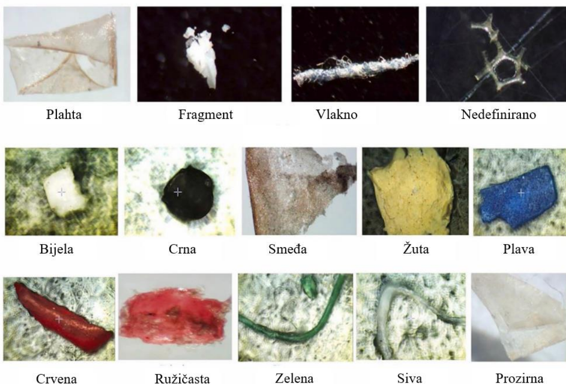
Slika 10. Karakteristične mikroplastike u postrojenjima za obradu otpadnih voda [13]
