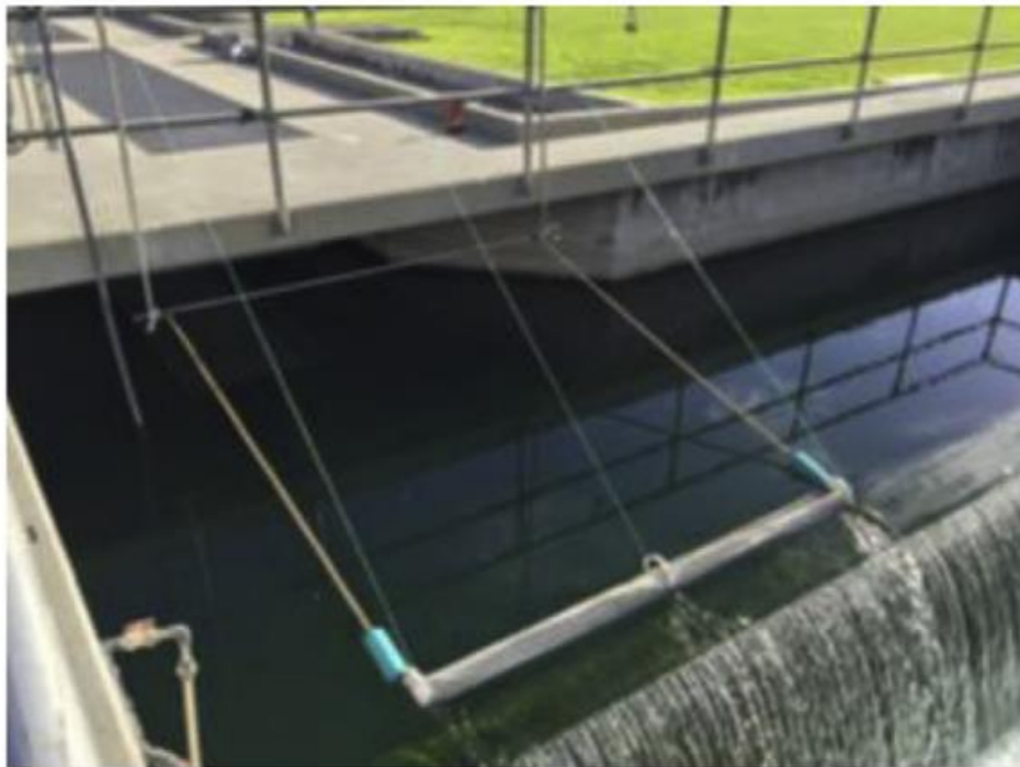
Slika 8. Sakupljanje mikroplastike pomoću sklopa s površinskim filtriranjem, Carr i suradnici, 2016. [26]
