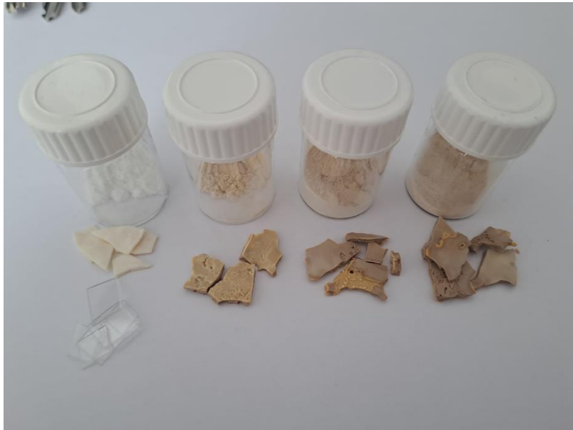
Slika 26. Prikaz usporedbe nestarenih uzoraka poli(etilen-tereftalata) (kristalni i amorfni) i starenih uzoraka tijekom 24, 48 i 72 h.
