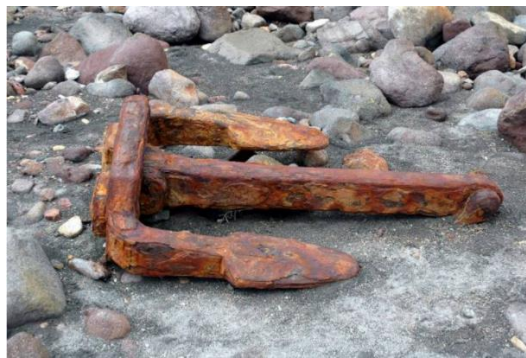
Slika 2.1. Prikaz jednolike korozije na sidru izložen morskoj vodi [2]
