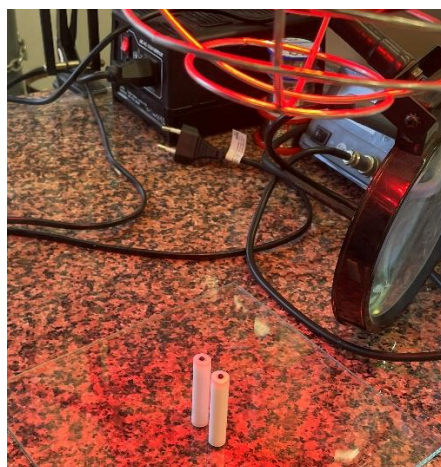
Slika 3.1. Sušenje GC elektroda na koje je nanesen alikvot otopine GO pod IR lampom.
