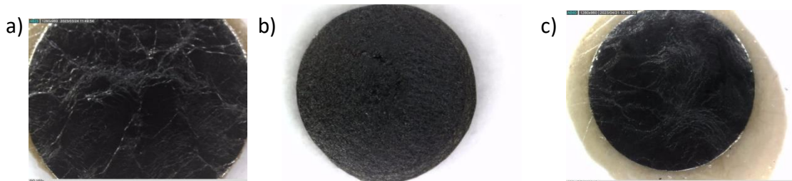
Slika 4.13. Izgled različitih GC elektroda snimljenih optičkim mikroskopom prije depozicije cinka.
