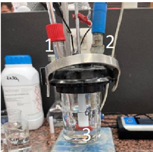
Slika 3.2. Troelektrodni sustav korišten u mjerenjima; 1 - protuelektroda, 2 – referentna elektroda, 3 – radna elektroda.
