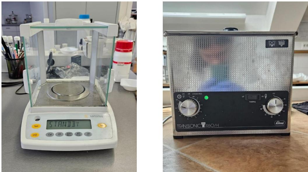
**Slika 14.** Analitička vaga Sartorius Libra Elektronik (lijevo) te ultrazvučna kupelj Elma Transsonic, 460H (desno).
