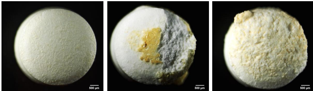
Slika 21. Stereomikrografije: eksperiment A1: dobro obložena tableta i loše obložena tableta (obje strane)
