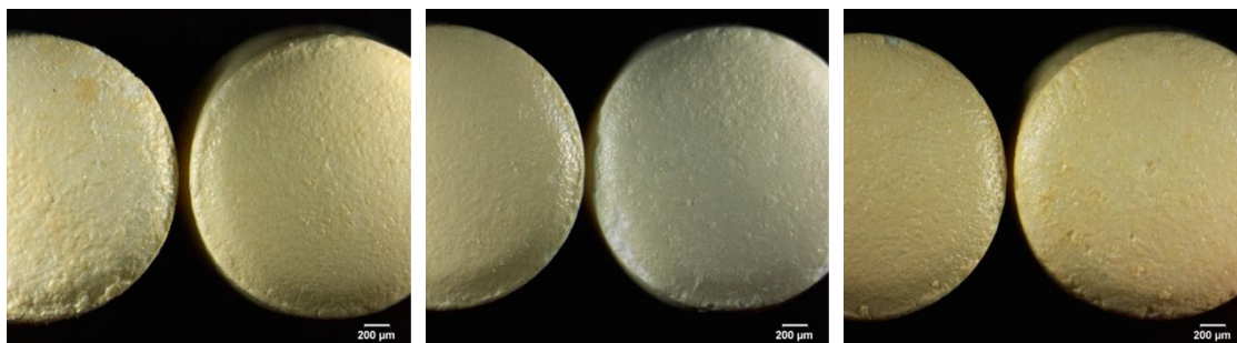
Slika 30. Stereomikrografije: usporedba dobro obloženih tableta A4/C4, C2/D4 i C5/B5
