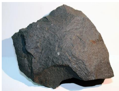
Slika 2.3. Maghemit, \gamma - \text{Fe}_2\text{O}_3 . [11]
