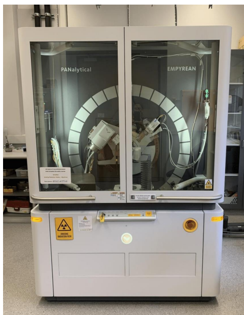
Slika 3.3. Difraktometar Panalytical Empyrean. [34]
