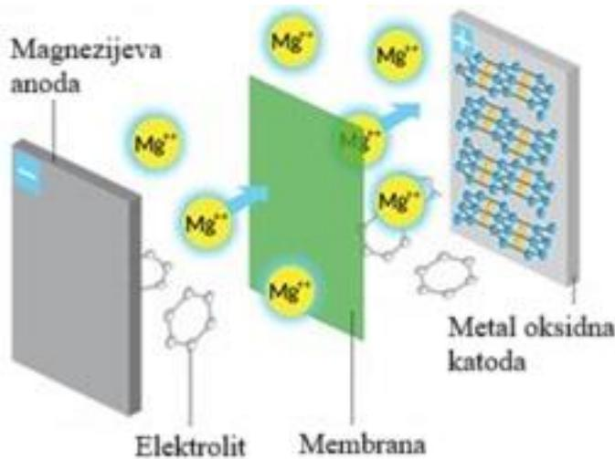
Slika 2.4. Shematski prikaz magnezijeve baterije sa anodom od legure kositra i magnezija i katodom od metalnog oksida. [27]
