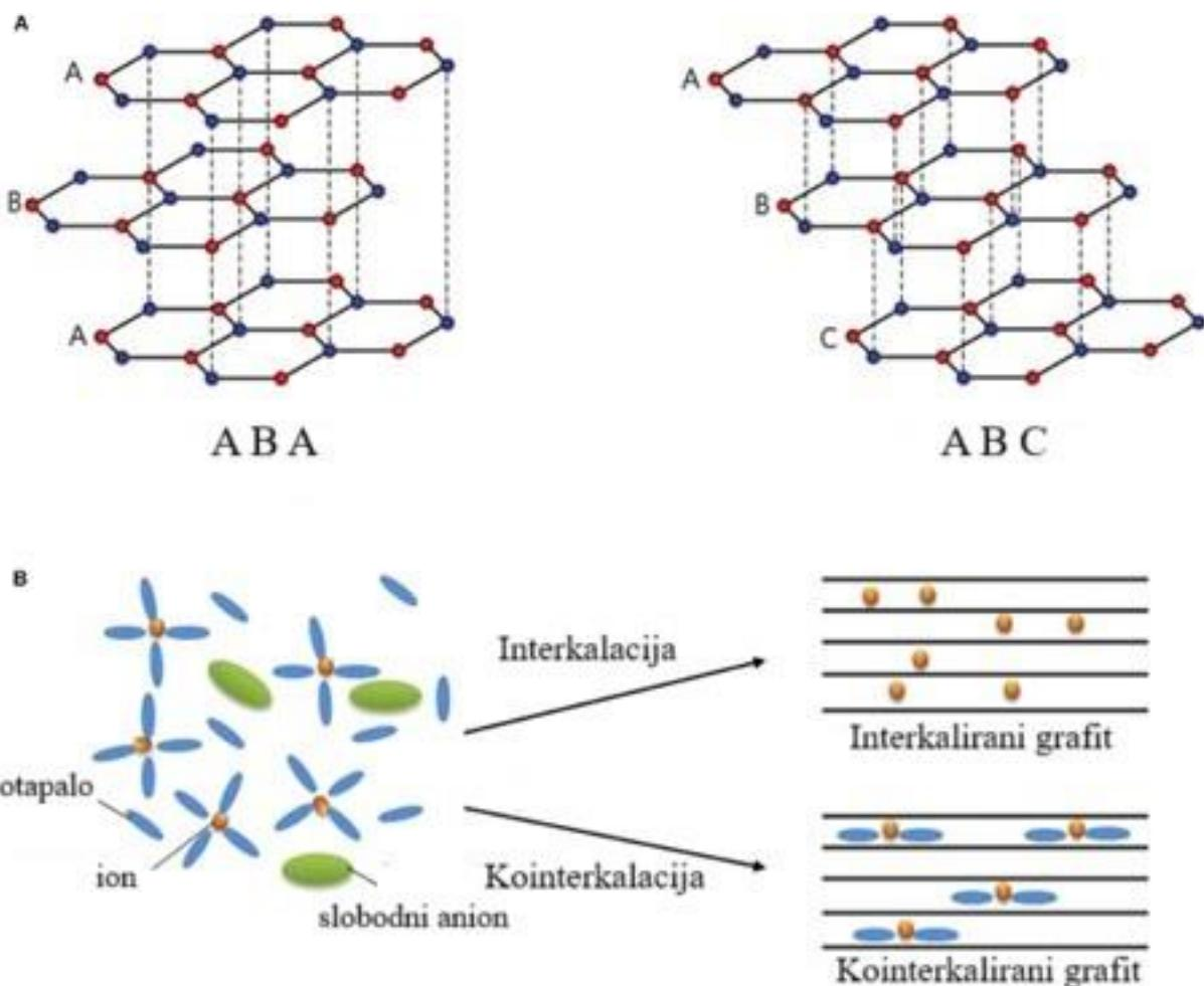
Slika 2.2.1. A) Shematski prikaz grafitnih struktura i B) koordinacijskih struktura u elektrolitu u interkaliranom i kointercaliranom grafitu. [20]
