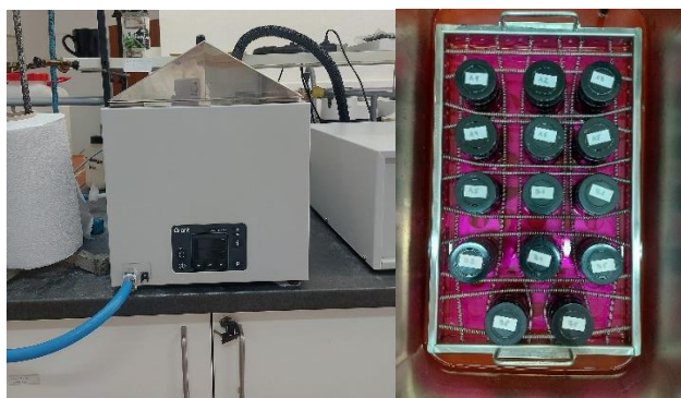
Slika 3.3. Termostatirana vodena kupelj s tresilicom
