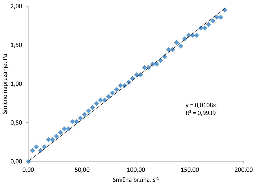
Slika 10. Grafički prikaz odnosa smične brzine i smičnog naprezanja 2%-tne otopine kitozana
