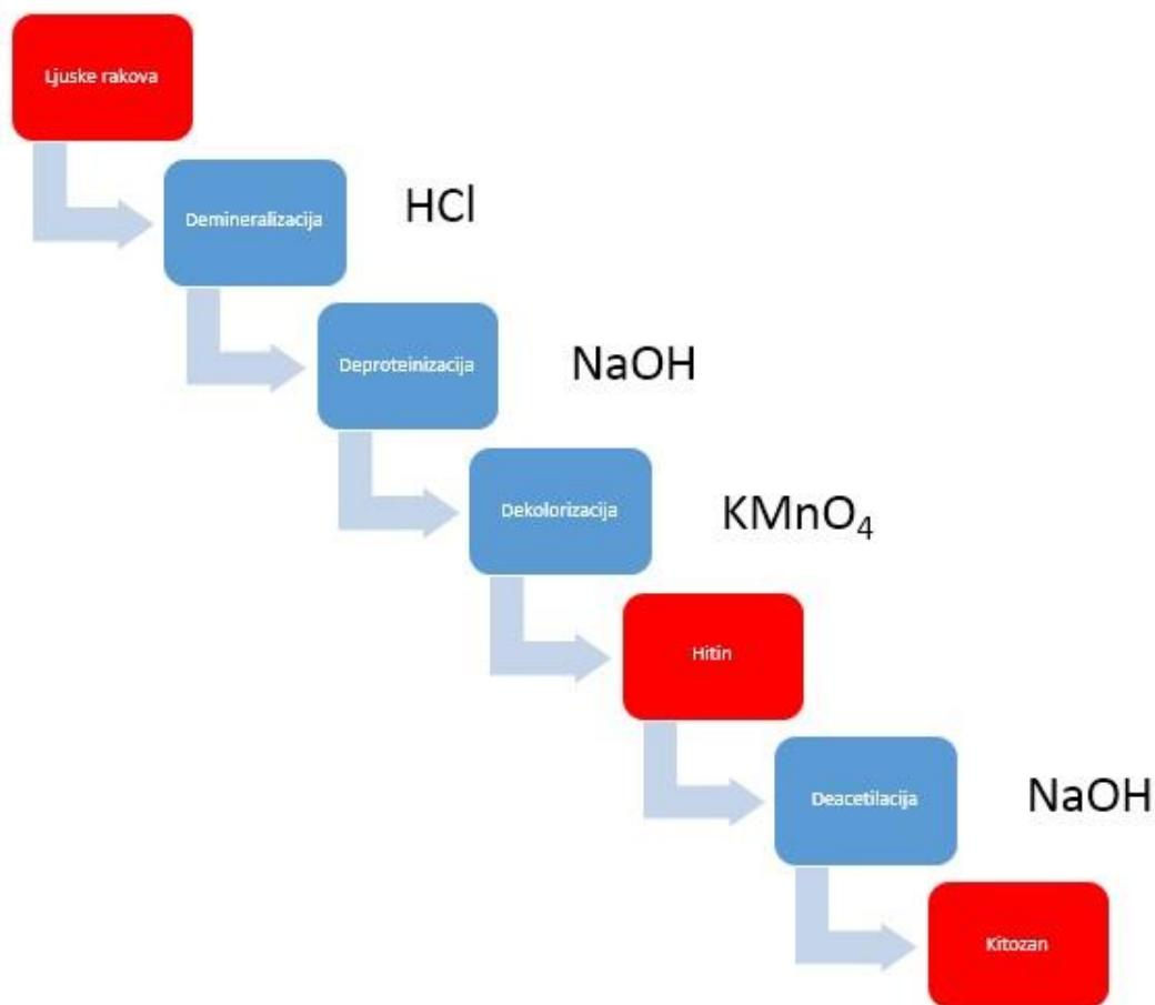
Slika 7. Shematski prikaz kemijskog postupka dobivanja kitozana [22]
