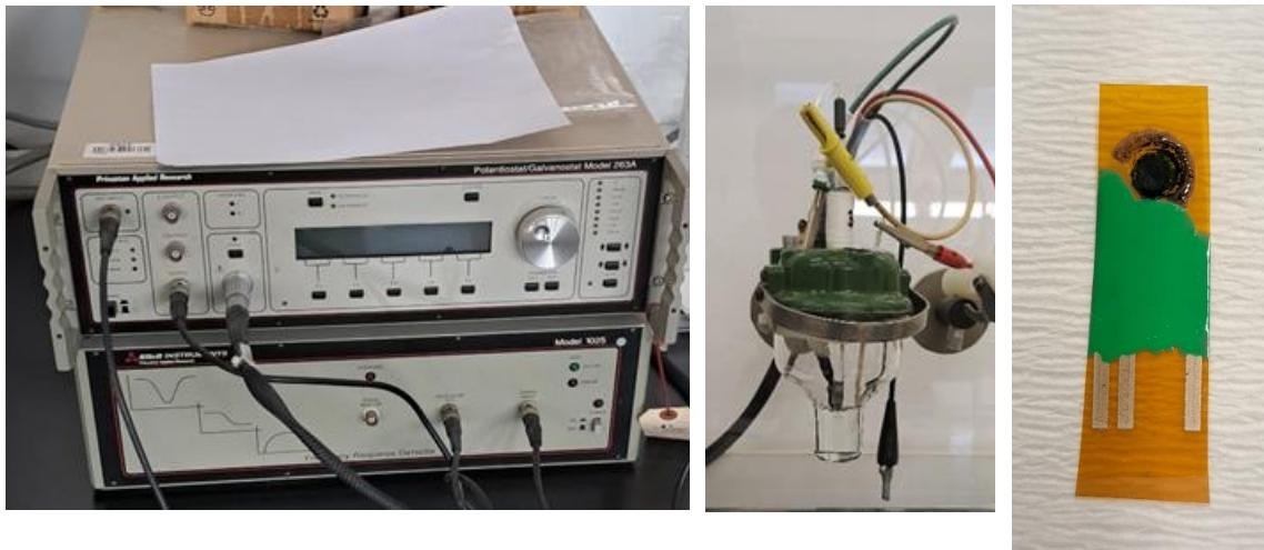
Slika 6. Prikaz aparature: potenciostat / galvanostat model 263A (lijevo), troelektrodna elektrokemijska čelija s GC elektrodom (u sredini) i *inkjet* printana elektroda (desno).
