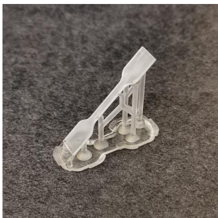
Slika 19. Primjer epruvete ispisane pod kutom 45° s osloncima
