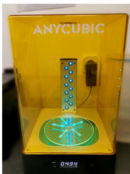
Slika 20. 405 nm komora za očvršćivanje
