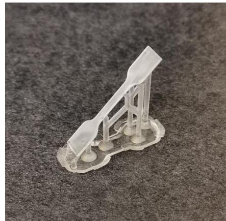
Slika 19. Primjer epruvete ispisane pod kutom  $45^\circ$  s osloncima
