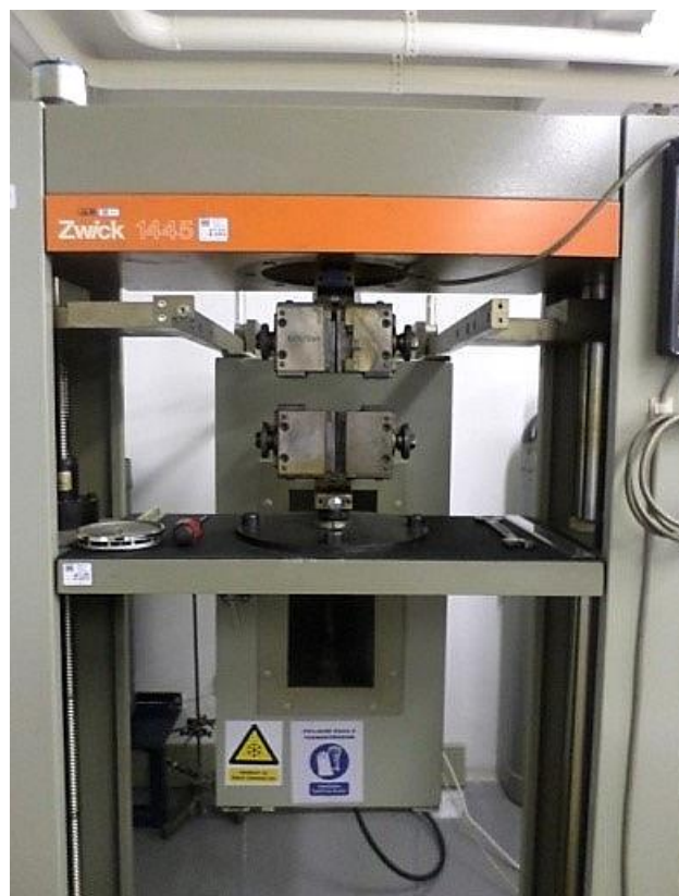
Slika 21. Kidalica UTM 1445 Zwick Röell, Njemačka
