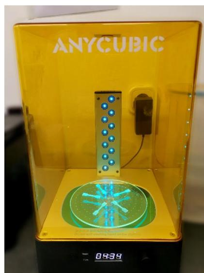
Slika 20. 405 nm komora za očvršćivanje
