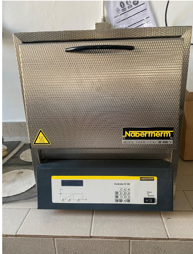
Slika 10. Peć u kojoj se provodi toplinska obrada.
