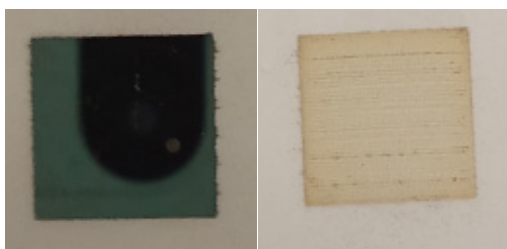
Slika 15. Prikaz usporedbe inkjet ispisanе tinte s amfifilnim nanočesticama srebra na staklu prije (lijevo) i nakon toplinske obrade (desno) pri 175 °C u trajanju od 80 min.
