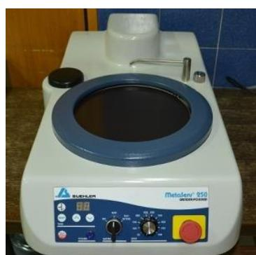
Slika 13. Uredaj za brušenje – Buehler MetaServ 250 [23]
