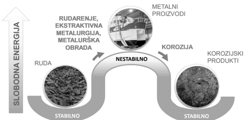
Slika 1. Termodinamički uzrok odvijanja korozije [2]
