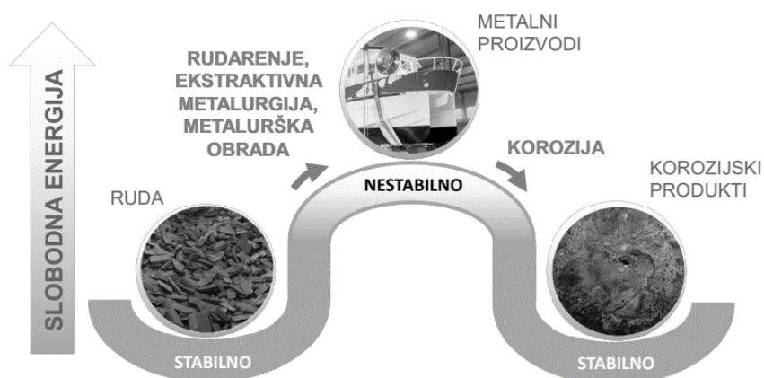
Slika 1. Termodinamički uzrok odvijanja korozije [2]
