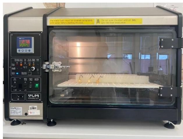
Slika 16. Uzorci izloženi vlažnoj komori
