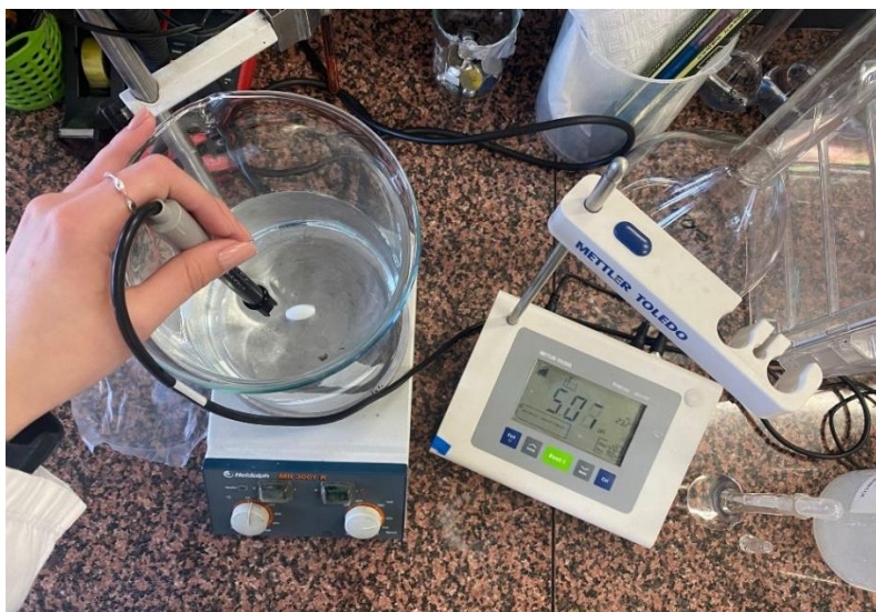
Slika 15. Zakiseljavanje otopine 0,5 M sumpornom kiselinom
