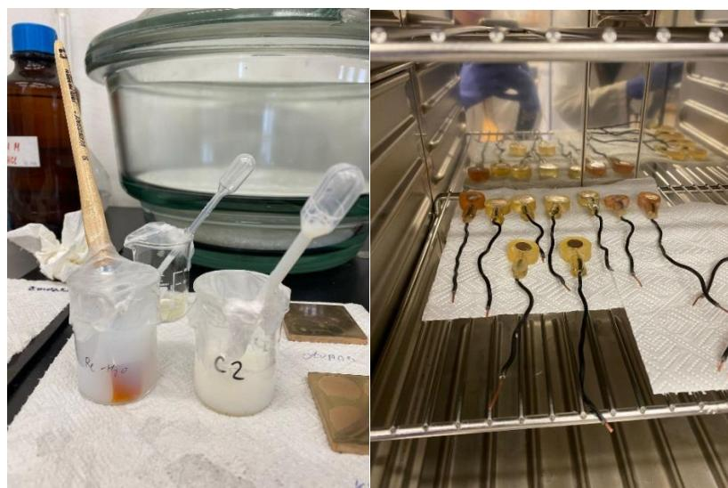
Slika 14. Priprema elektroda nanošenjem vodorazjedivog premaza i sušenjem u peći na 40°C
