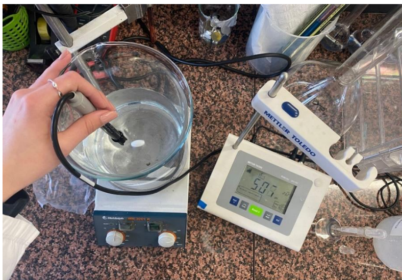
Slika 15. Zakiseljavanje otopine 0,5 M sumpornom kiselinom
