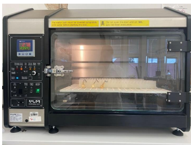
Slika 16. Uzorci izloženi vlažnoj komori
