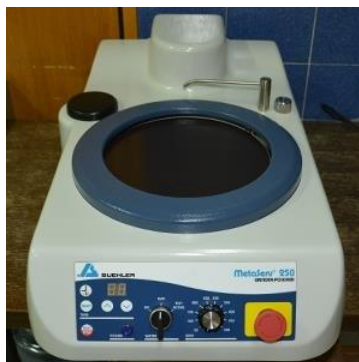
Slika 13. Uređaj za brušenje – Buehler MetaServ 250 [23]
