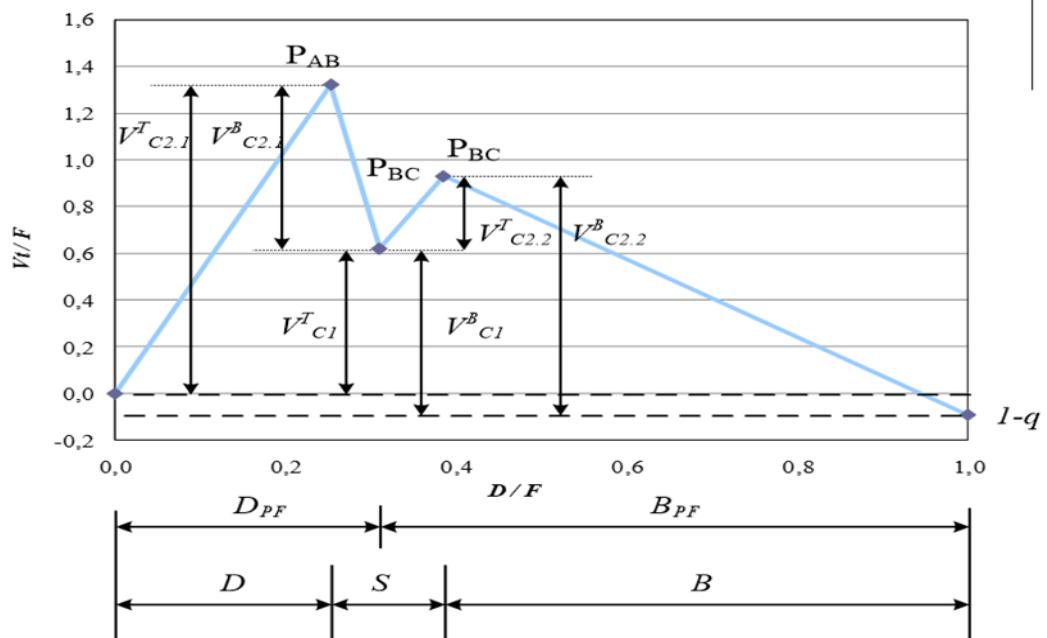
**Slika 3.6.** Konstrukcija  $V_{min}$  dijagrama [7]
