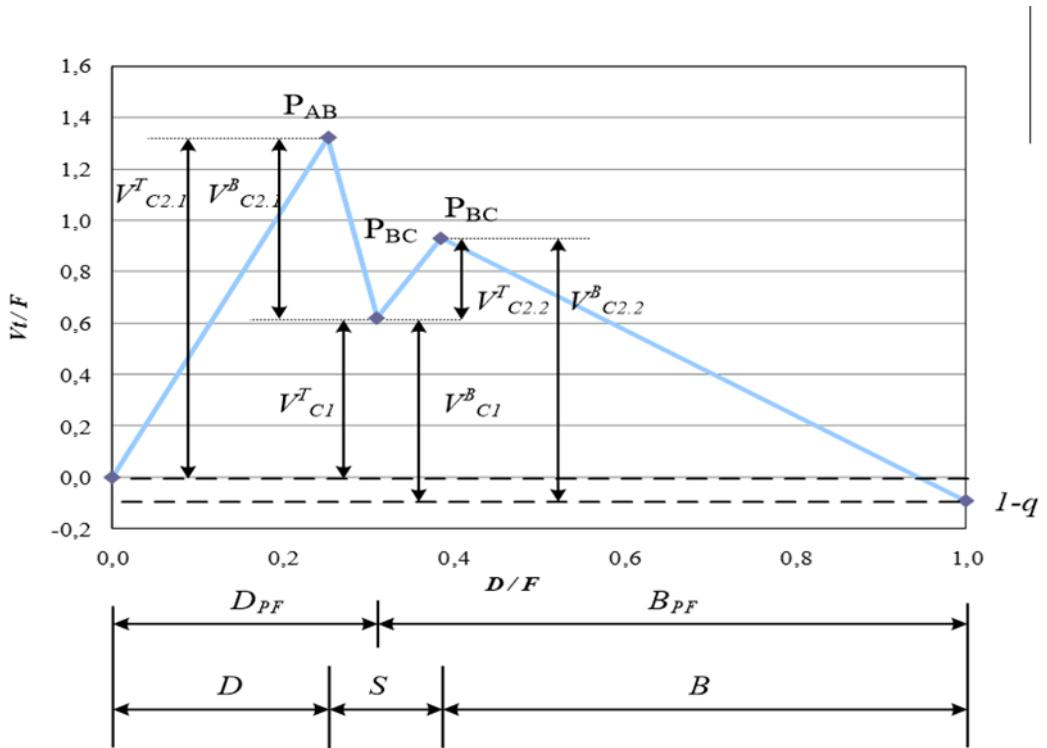
Slika 3.2. Primjer  $V_{\min}$  dijagrama za trokomponentnu smjesu ABC [11]
