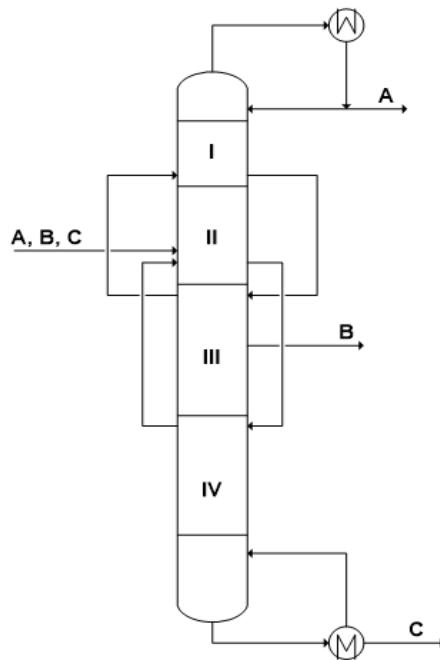
**Slika 2.9.** Pump – around model za kolonu s razdjelnom stijenkama za tri proizvoda [15]
