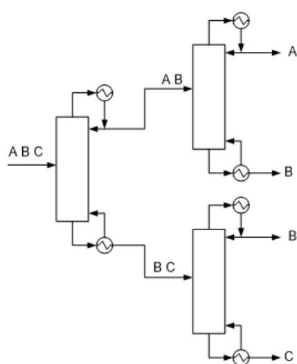
**Slika 2.4.** „Sloppy“ niz za separaciju trokomponentne smjese [7]
