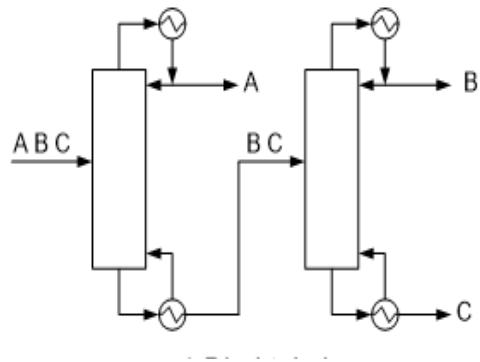
**Slika 2.2.** Direktan niz za separaciju trokomponentne smjese [7]
