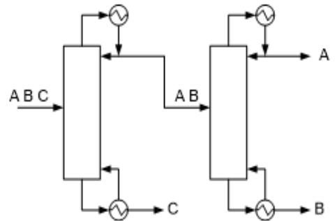
**Slika 2.3.** Indirektan niz za separaciju trokomponentne smjese [7]
