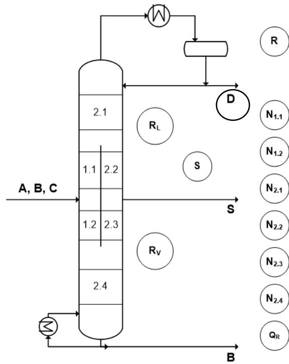
**Slika 2.11.** Grafički prikaz modeliranja pojedinih sekcija u KRS-u kao i parametri koje treba podesiti za dobro dimenzioniranje i vođenje kolone [7]
