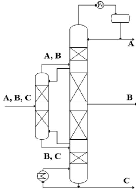
**Slika 2.6.** Petlyukov niz za višekomponentnu smjesu za tri proizvoda [7]
