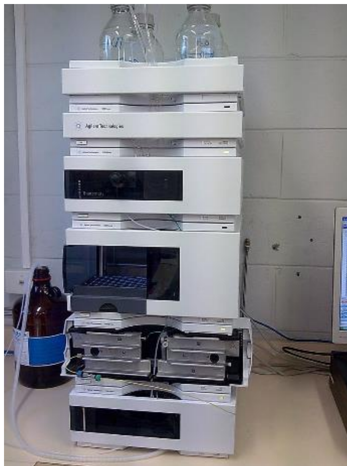
Slika 5. Suvremeni uređaj za tekućinsku kromatografiju [25].
