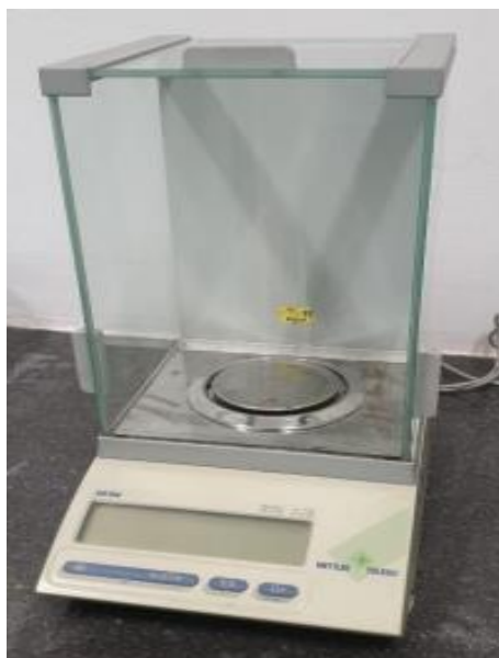
Slika 7. Analitička vaga (Mettler Toledo, AB 104, Švicarska).
