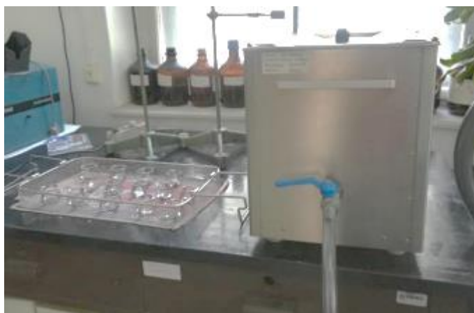
Slika 8. Ultrazvučna kupelj SONOREX DIGITAL 10 P, Bandelin, Berlin Njemačka 1200 W.
