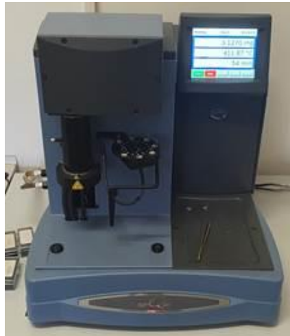
Slika 15. Termogravimetar, Q500 TA Instruments
