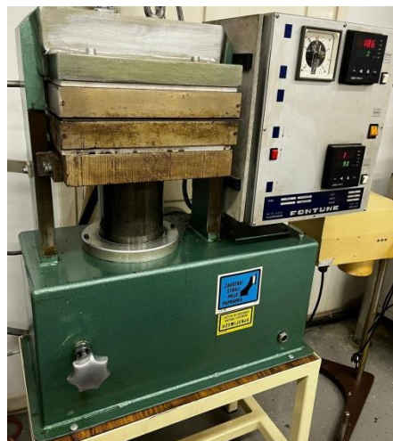
Slika 13. Hidraulička preša Fontune, Holland (SRB 140, EC 320x320NB)
