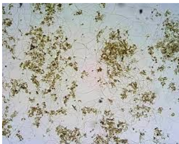
Slika 7. Mikrofotografija pahuljica aktivnog mulja [22]
