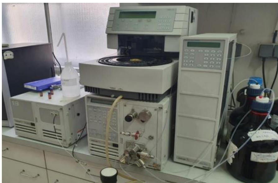
Slika 20. Kromatograf Varian ProStar, SAD
