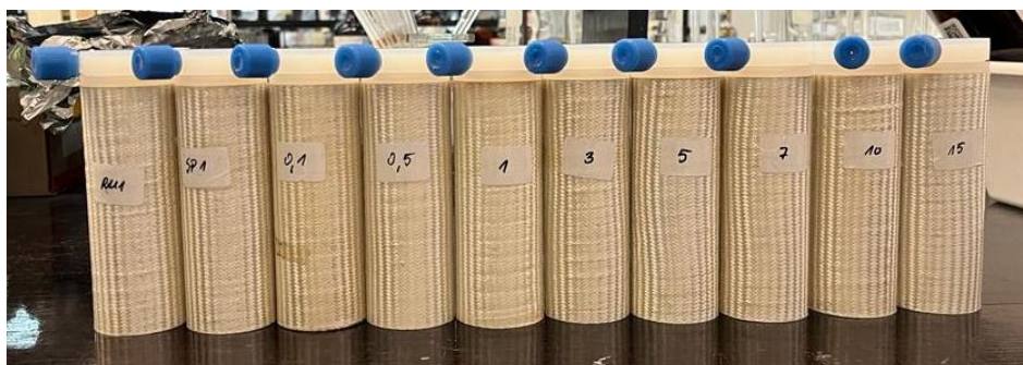
Slika 17. Teflonske „GreenChem“ posude volumena 100 mL
