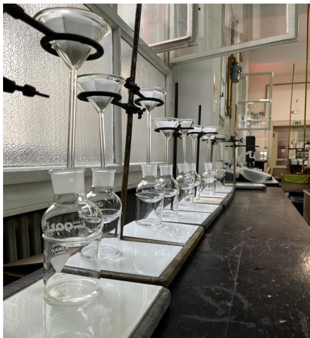
Slika 23. Standardna aparatura za filtraciju
