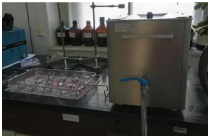
Slika 18. Ultrazvučna kupelji SONOREX DIGITAL 10P, Bandelin, Berlin, Njemačka, 1200W
