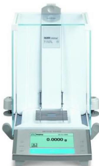
Slika 14. Analitička vaga Mettler Toledo, XA105 [44]
