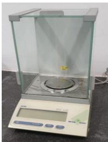
Slika 13. Analitička vaga Mettler Toledo, AB 104, Švicarska
