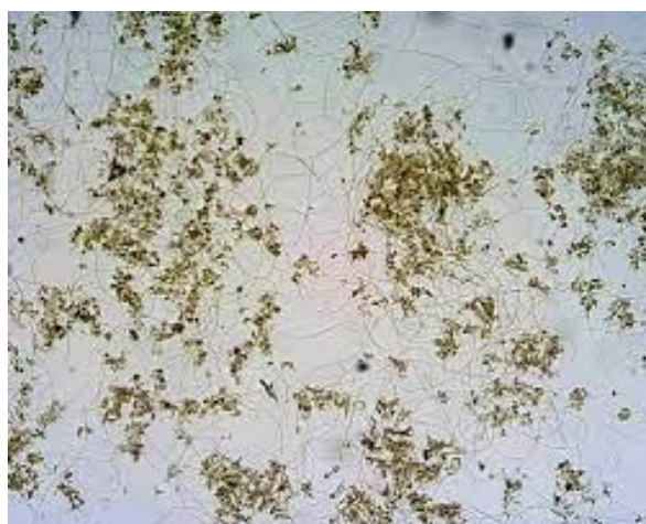
Slika 7. Mikrofotografija pahuljica aktivnog mulja [22]
