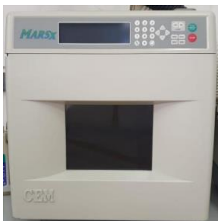
Slika 16. Uređaju za mikrovalnu ekstrakciju i digestiju MarsX (CEM, Matthews, NC, USA) 1200 W
