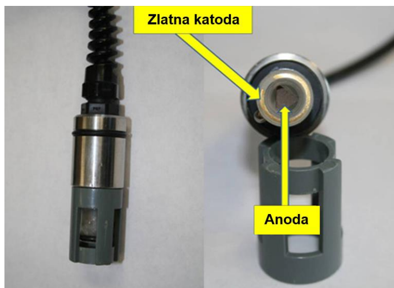
Slika 15. Membranska elektroda koja se koristi za mjerenje otopljenog kisika [6]
