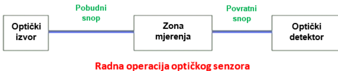
Slika 28. Općeniti prikaz radne operacija optičkog senzora [29]
