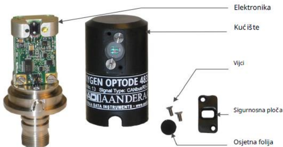
Slika 41. Ilustracija unutrašnjosti Aanderaa Oxygen Optode 4835 [38]
