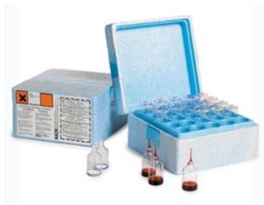
Slika 14. Aparatura kolorimetrijske metode [11]
