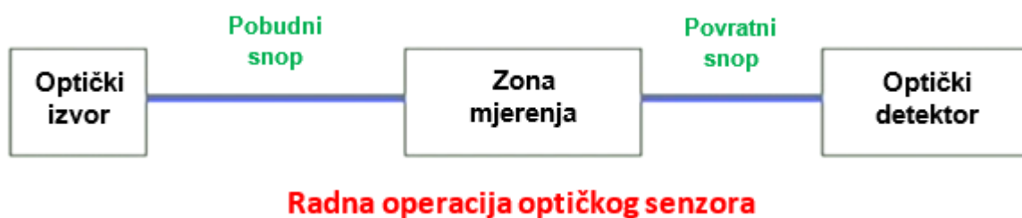
Slika 28. Općeniti prikaz radne operacija optičkog senzora [29]
