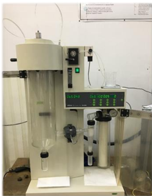
Slika 9. Fotografija laboratorijskog sušionika s raspršivanjem Mini Spray-Dryer B-290 (Büchi Labortechnik AG, Flawil, Switzerland)
