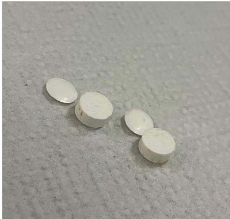
Slika 22. Prikaz neželjenog fenomena cappinga
