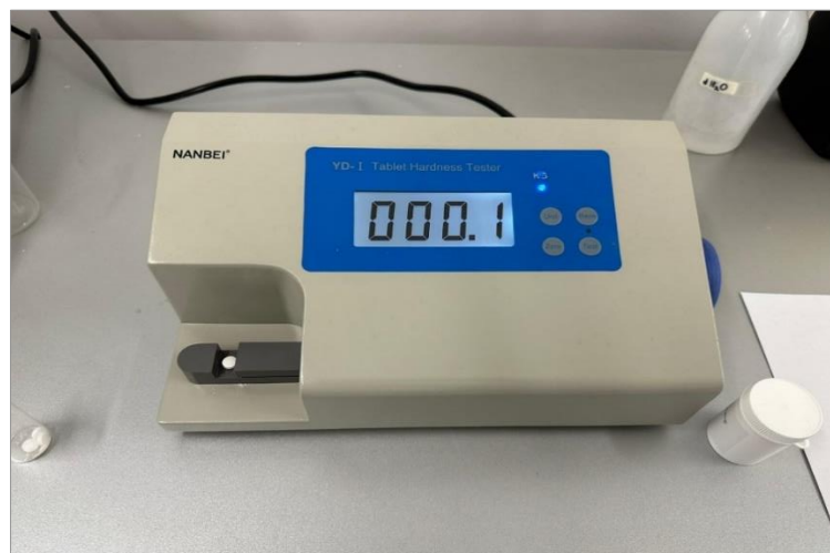
Slika 10. Fotografija uređaja za određivanje tvrdoće tableta YD – 1 Tablet Hardness Tester (Zhengzhou Nanbei Instrument, Henan, NR Kina)
