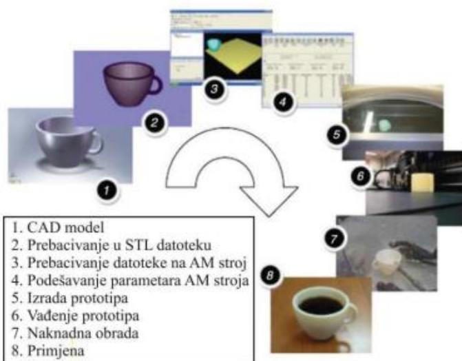
**Slika 2.6.** Prikaz pojedinih stupnjeva procesa aditivne proizvodnje[22]
