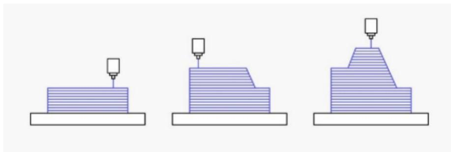
Slika 2.5. Izrada proizvoda tehnikom sloj po sloj.[20]
