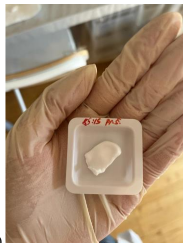
Slika 23. Izgled hidrogela PLA + p.š./NMP (omjer 85:15) nakon a) 24 h i b) 336 h bubrenja
