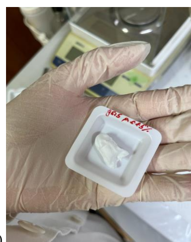
Slika 18. Izgled hidrogela PLA + p.š. + 5 mas. % l.k./NMP (omjer 95:5) nakon a) 24 h i b) 336 h bubrenja
