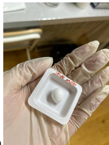
Slika 20. Izgled hidrogela PLA + p.š./NMP (omjer 90:10) nakon a) 24 h i b) 336 h bubrenja
