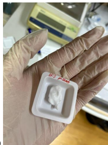
Slika 17. Izgled hidrogela PLA + p.š./NMP (omjer 95:5) nakon a) 24 h i b) 336 h bubrenja
