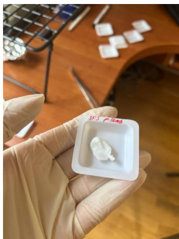
Slika 17. Izgled hidrogela PLA + p.š./NMP (omjer 95:5) nakon a) 24 h i b) 336 h bubrenja
