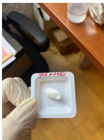
Slika 18. Izgled hidrogela PLA + p.š. + 5 mas. % l.k./NMP (omjer 95:5) nakon a) 24 h i b) 336 h bubrenja
