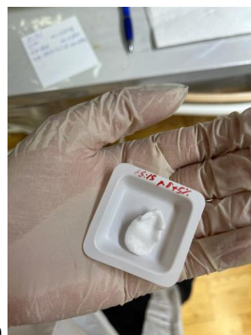
Slika 24. Izgled hidrogela PLA + p.š. + 5 mas. % l.k./NMP (omjer 85:15) nakon a) 24 h i b) 336 h bubrenja
