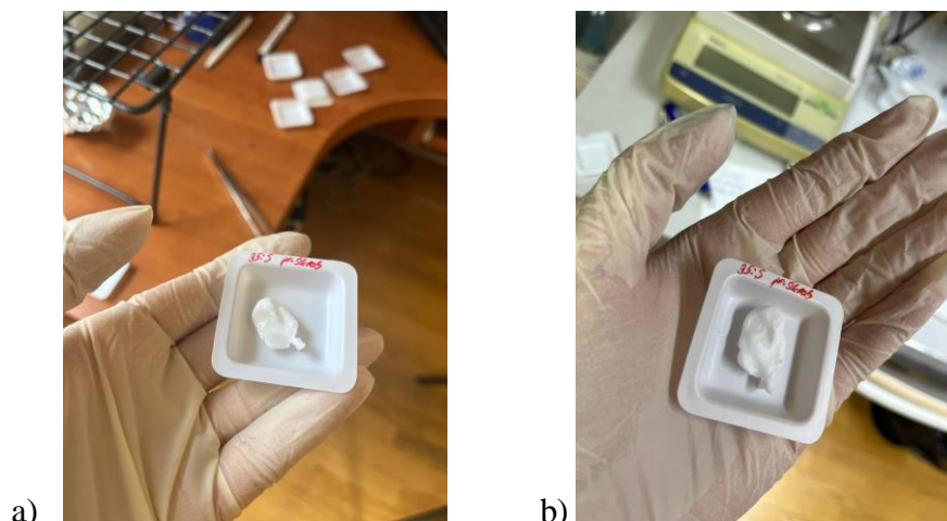
a) b) Slika 17. Izgled hidrogela PLA + p.š./NMP (omjer 95:5) nakon a) 24 h i b) 336 h bubrenja
