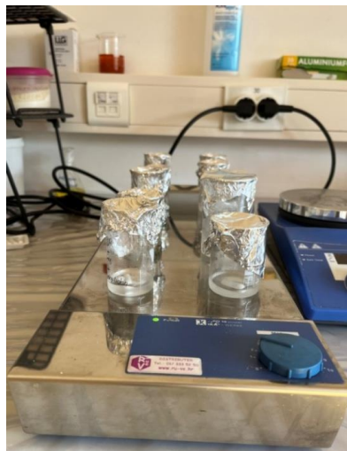
Slika 12. Pripremljene polimerne otopine na magnetskoj mješalici
