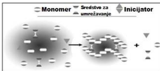
Slika 4. Shematski dijagram pripreme hidrogela [12]
