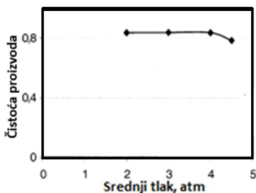
Slika 23. Ovisnost čistoće proizvoda o srednjem tlaku[13]
