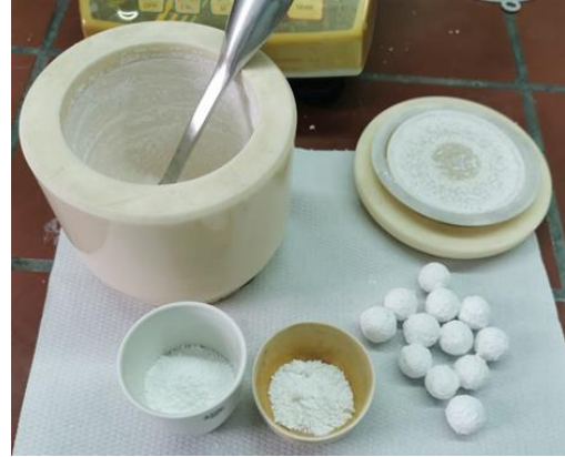
Slika 12. Prikaz planetarnog mlina Pulverizette (lijevo), posude i kuglica za miješanje (desno)
