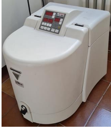
Slika 12. Prikaz planetarnog mlina Pulverizette (lijevo), posude i kuglica za miješanje (desno)
