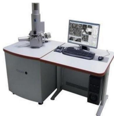
**Slika 20.** Pretražni elektronski mikroskop Tescan Vega 3
