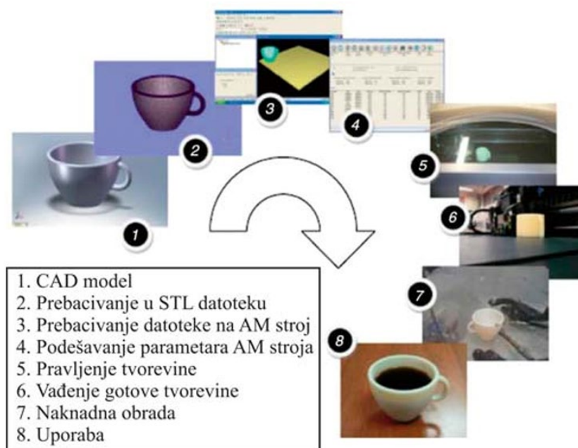
Slika 21 Faze općenitog postupka aditivne proizvodnje [43].
