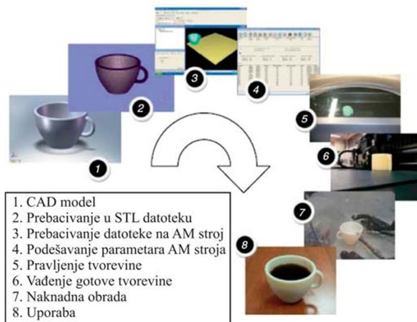
Slika 21 Faze općenitog postupka aditivne proizvodnje [43].
