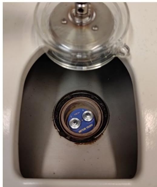
Slika 34 Uzorak i referentan uzorak postavljeni u ispitnu komoru.
