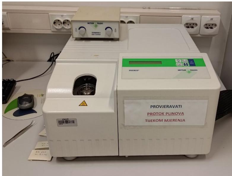
Slika 33 Uređaj Mettler Toledo DSC823e
