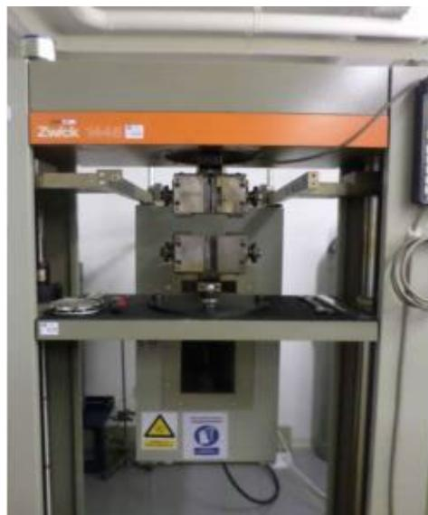
Slika 35 Kidalica UTM 1445 Zwick Röell
