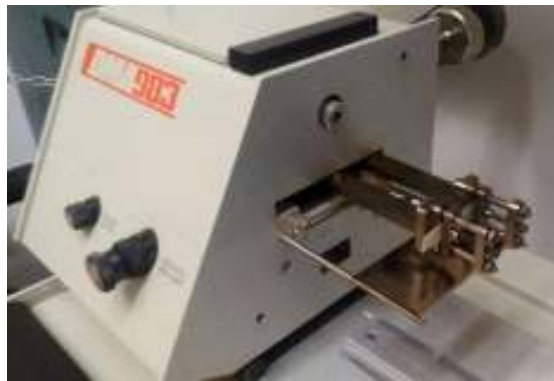
Slika 20. Dinamičko mehanički analizator DMA 983, TA instruments.
