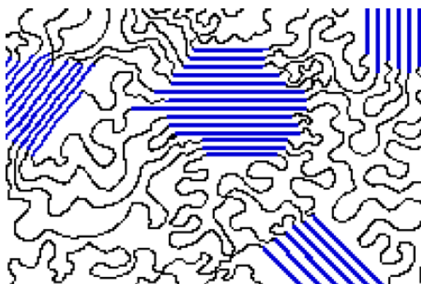
Slika 4. Shematski prikaz kristalnih i amornih područja u polietilenu [8]
