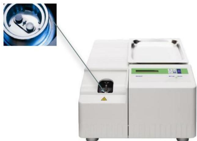
**Slika 7.** Prikaz DSC uređaja (Mettler toledo DSC 823 e). [7]
