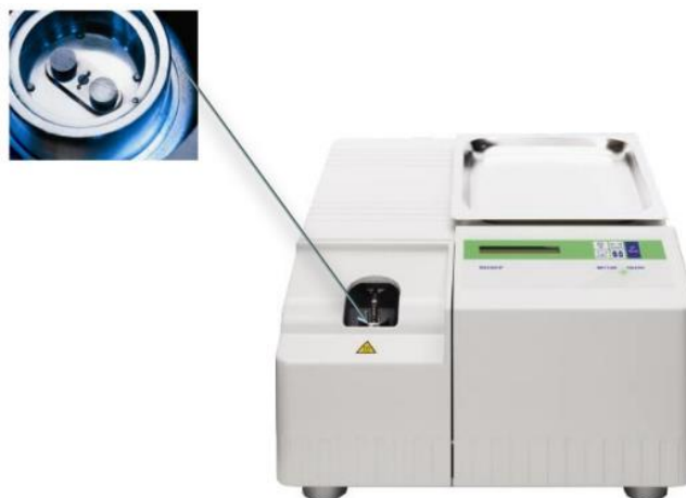
Slika 7. Prikaz DSC uređaja (Mettler toledo DSC 823 e). [7]
