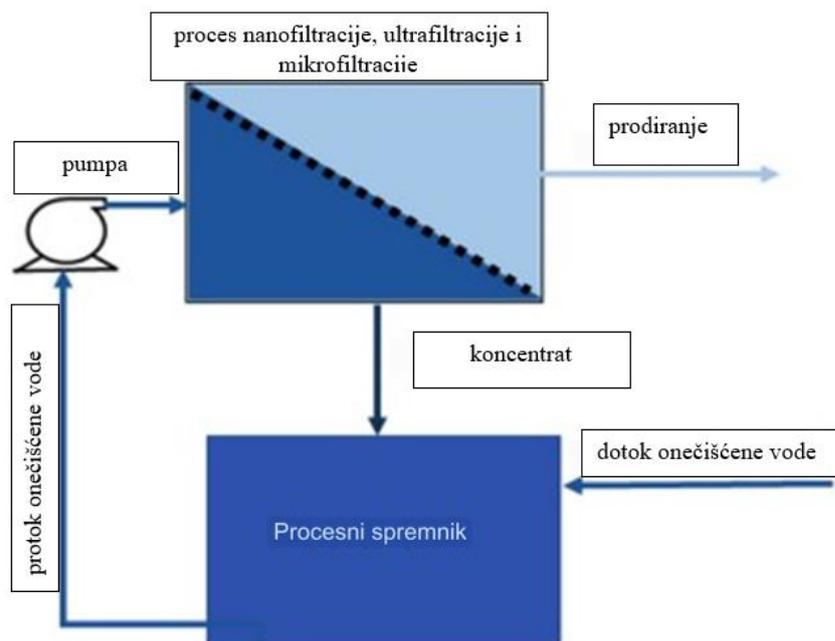
Slika 3.13. Shema procesa nanofiltracije, ultrafiltracije i mikrofiltracije
