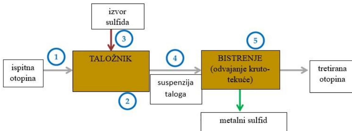
Slika 3.2. Shema procesa taloženja metalnih sulfida
