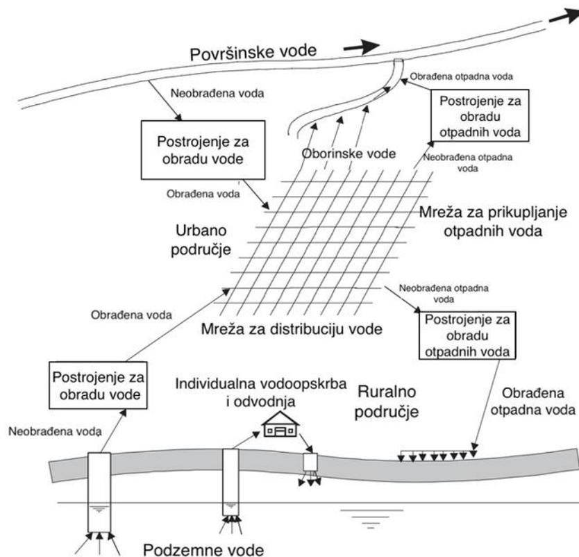
Slika 2.3. Obrada vode i njeni putevi primjene<sup>[8]</sup>
