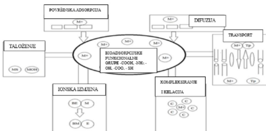
Slika 3.18. Prikaz mehanizma bioadsorpcije,  $M^+$  : ioni teških metala,  $C$ : kelirajuća sredstva,  $BE$ ., molekule sa izmjenjenim ionima,  $BM$ : molekule sa metalnim ionima,  $TP$ : transportni protein
