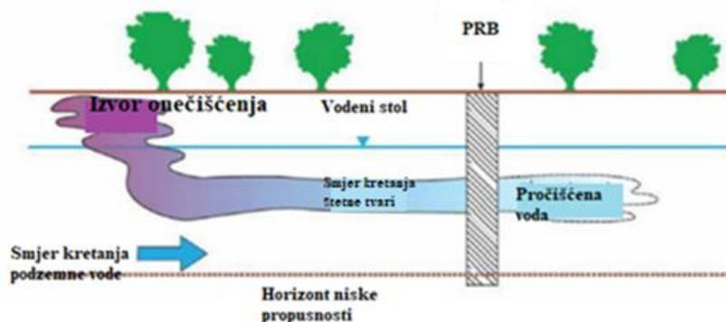
Slika 3.15. Slikoviti prikaz metode in situ remedijacije primjenom permeabilne reaktivne barijere (PRB)
