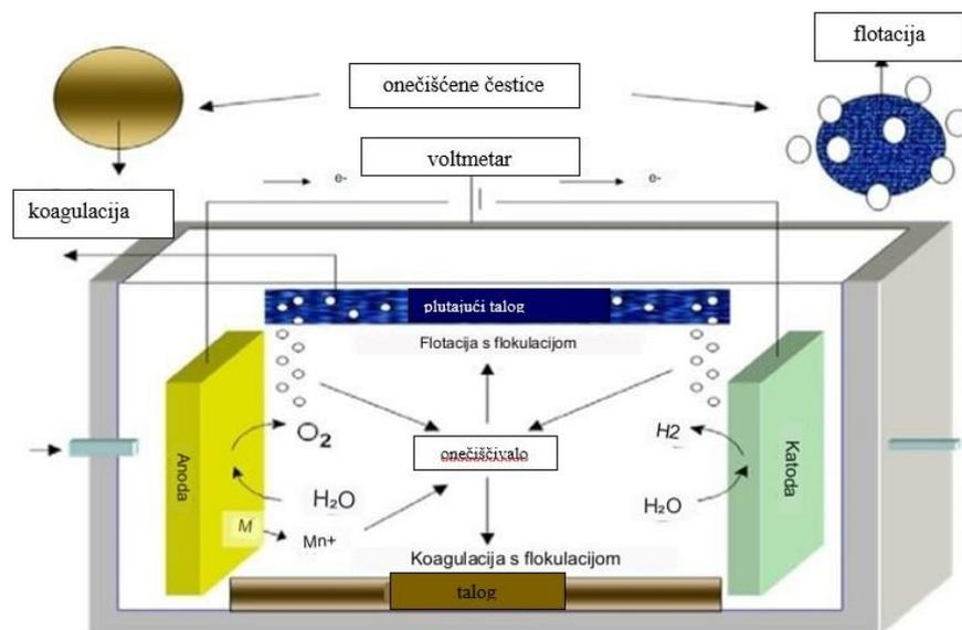
Slika 3.10. Prikaz elektroflotacije
