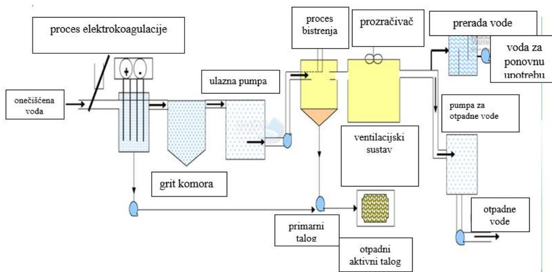
Slika 3.9. Shema procesa elektrokoagulacije onečišćenih voda
